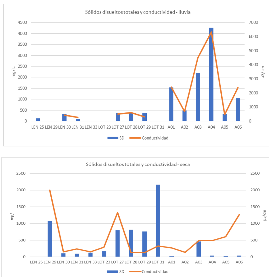
Figura 5-47. Sólidos disueltos totales y conductividad (lluvia y seca).
