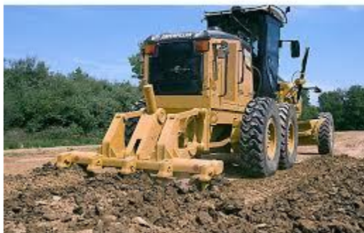
Fotografía 10-1 Proceso de escarificación mecánica del suelo
