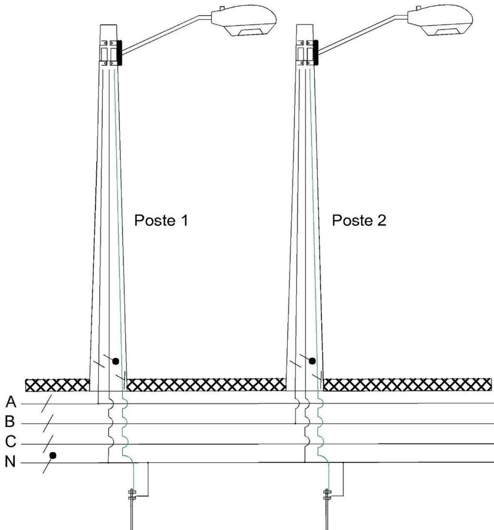
Figura 2. Conexión de puesta a tierra de AP exclusivo poste metálico
