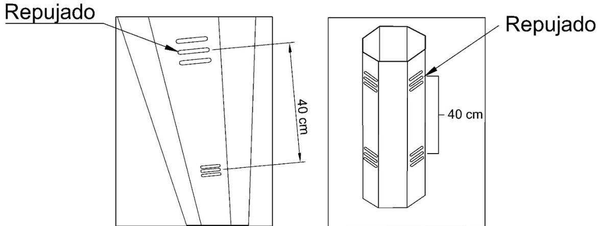
**FIGURA 3 DETALLE PUESTA A TIERRA SUPERIOR**
