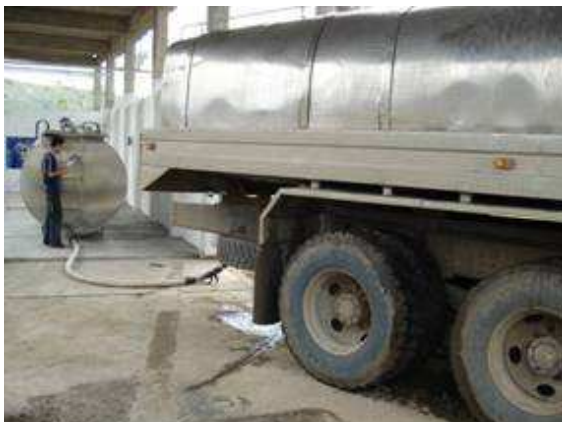
Fotografía 95 Traspaso de la leche del tanque de enfriamiento al vehículo para su transporte a la planta de procesamiento en Florencia
